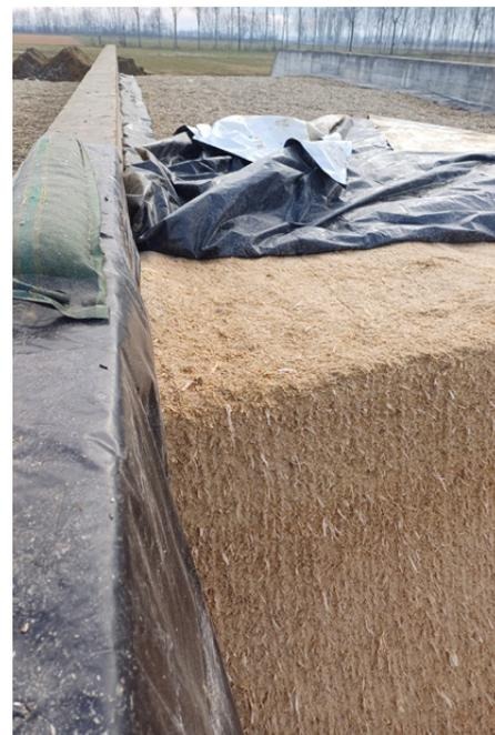
**Foto 1 - Il film sulle pareti protegge i manufatti dalla corrosione, permette di sigillare meglio le zone periferiche del silo e riduce i rischi di danneggiamento delle coperture**
